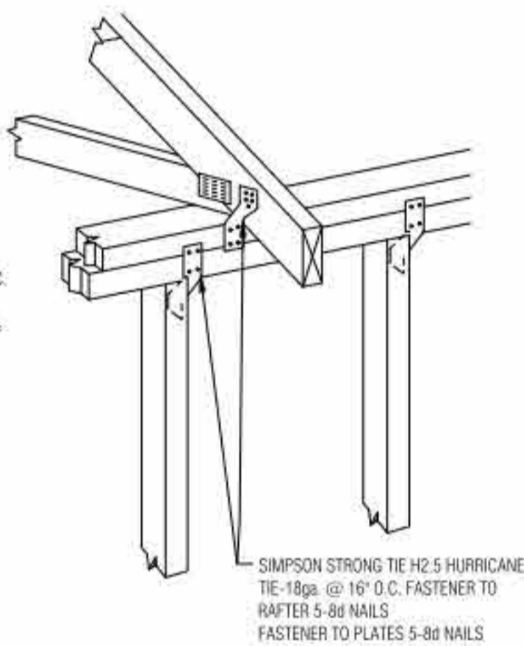
5 ROOF TRUSS DETAIL SCALE: N.T.S
